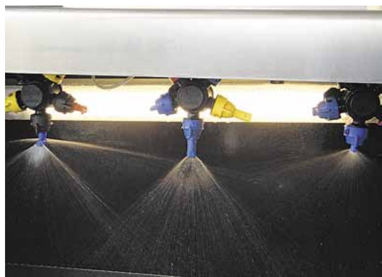
— Dubbelspaltmunstycken på båda sidor, injet i mitten. —
