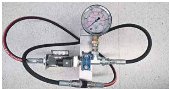
— Utrustning för mätning av tryck och flöde för högtryckspump. —
