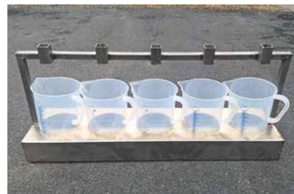
— Mätkärl för kontroll av levererad vätskemängd för de olika munstyckena. —
