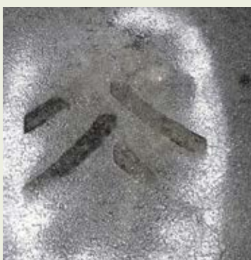
Stor skillnad på anläggningsytan mot marken beroende på lufttryck i däck 0,6 kg > 1,2 kg.
