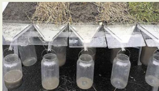
Regnsimulator som visar genomsläpplighet och ytvärrning beroende på behandlingssätt.
