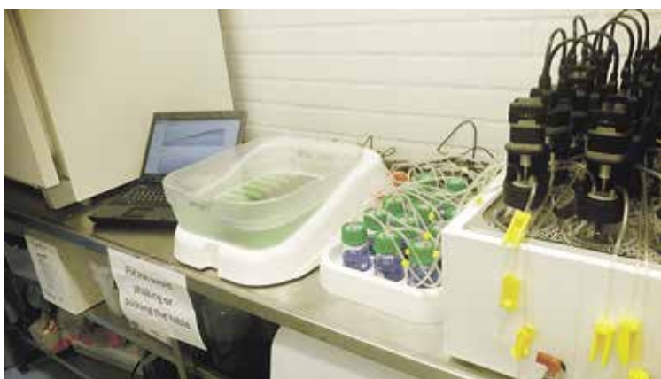
— Utrustning för att mäta metanpotentialer vid Yrkeshögskolan Novia.
