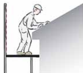
— Byggnadsställning vid tak- och takfotsarbete. —
